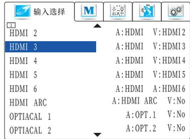
提供所有信号输入的选择功能,并显示音视频源输入口。
