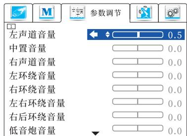
针对每个声道独立的输出电平增益调节,这里针对不同的扬声器布局,显示不同,当扬声器布局中没有的通道,显示为灰色,无法进行调节;
