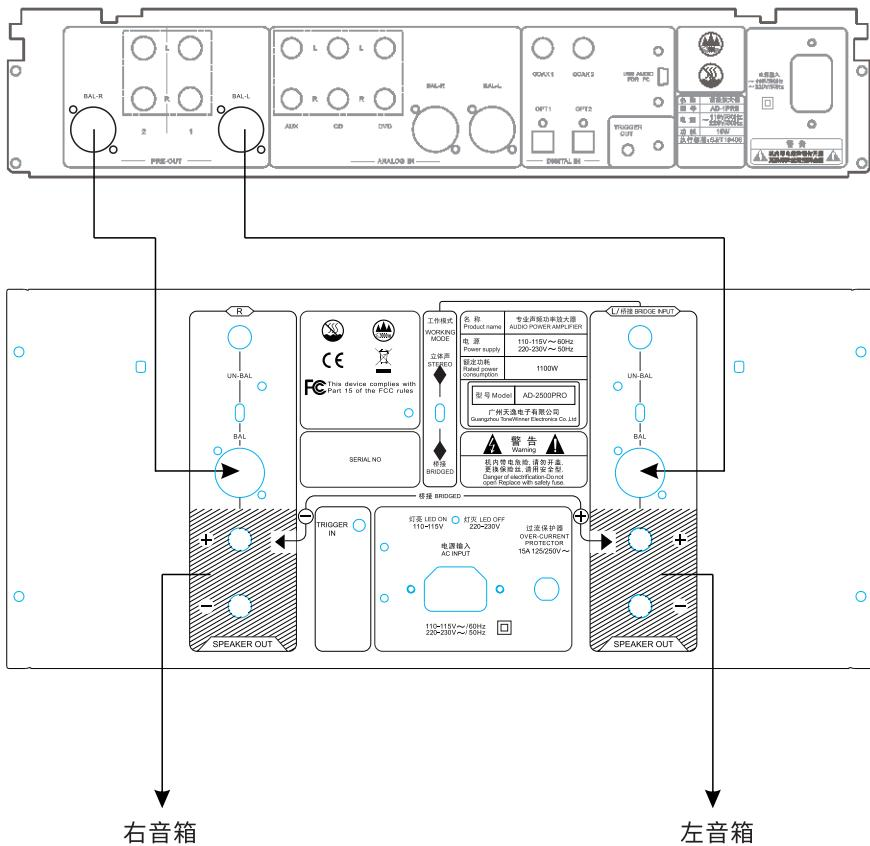
备注：信号通道选择开关应拨到平衡信号端。
