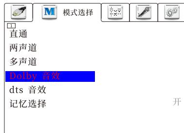
仅对当前输入片源进行对应的DSP音效处理，并非对所有信号源进行设置；
