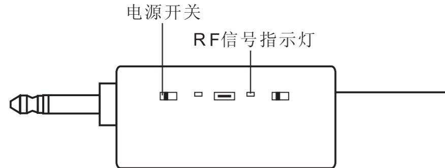
第③步：短按一下发射器调频按键，以确认发射器和接收器的连接，此时，发射器显示屏停止闪动，接收器 RF 信号指示灯常亮，说明接收器与发射器已连接成功，可正常使用；
